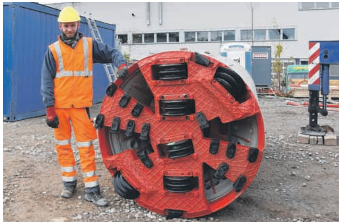
Ein österreichischer Mitarbeiter der Firma Braumann zeigt die Tunnelbohrmaschine mit einem Durchmesser von 1,5 Metern. Bild Patrizia Pfister
