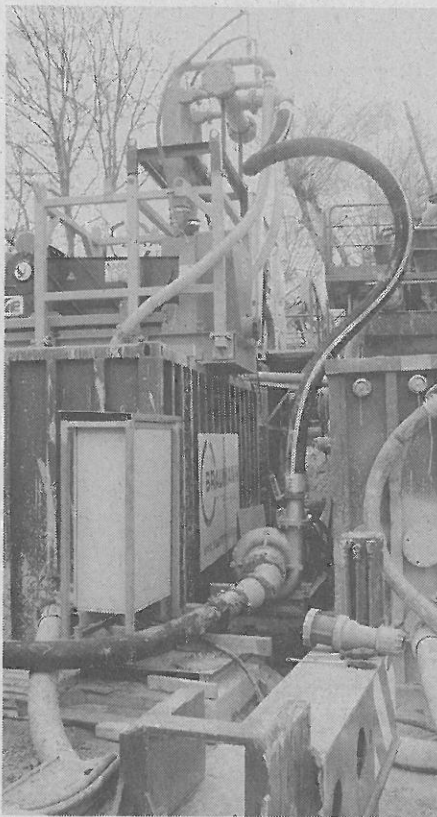
Die Separationsanlage der ITE ist der konventionellen Entsandungsanlage nachgeschaltet, um so einen höheren Abscheidegrad zu erzielen. Wirken alle Komponenten zusammen – also Siebanlagen, Hydrovakuumzyklone, Vibrationsmaschinen und Zentrifuge – handelt es sich um ein geschlossenes System. Foto: ITE
